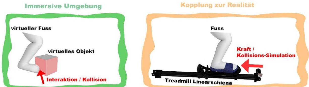
Abbildung 29 Haptisches Force Feedback
