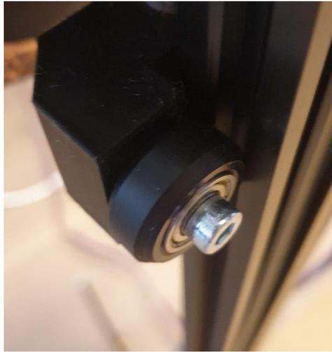
Abbildung 21B V-Slot Rollen
