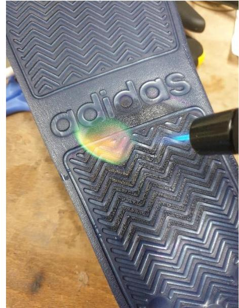
Abbildung 35C Aufrauen der Oberfläche für Klebevorgang
