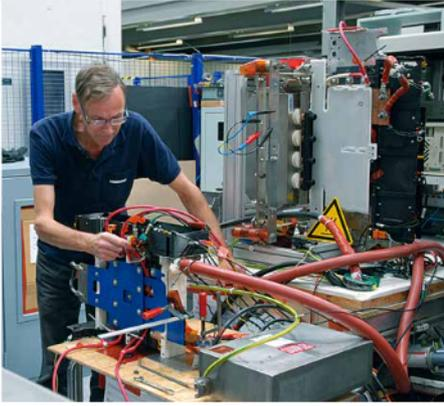
**2 Prüfstände für Halbleiter-Module**
